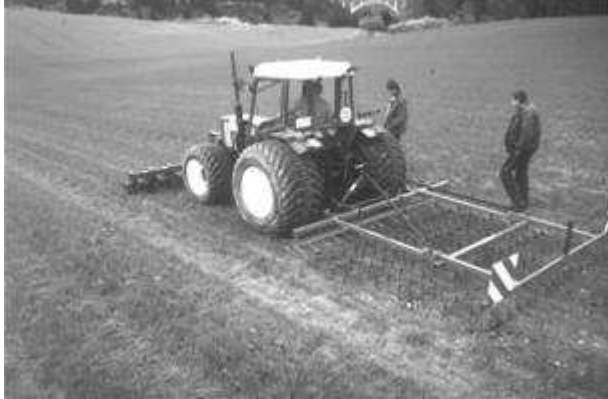
Auch im Ökolandbau kommt moderne Technik zum Einsatz: Kombination von Hacke und Netzege zur mechanischen Unkrautbekämpfung Foto: Ostarhild
