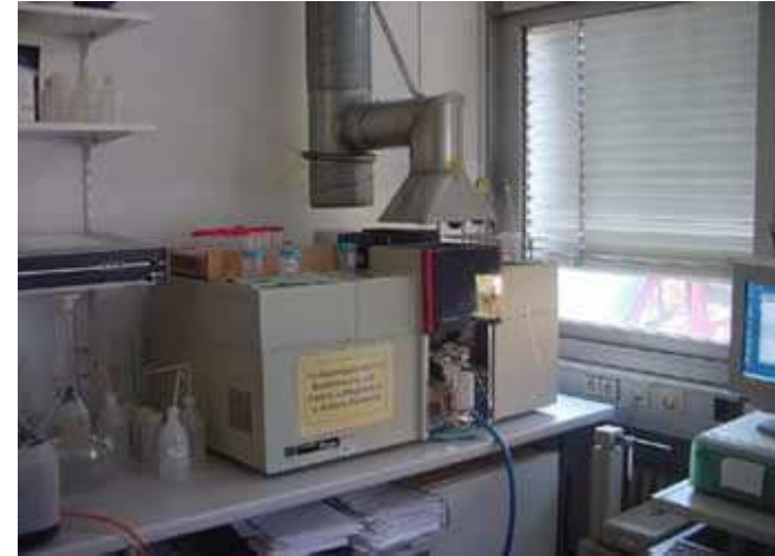
Fotometrische Bestimmung von Magnesium
